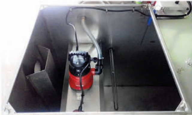
Atık Yağ Pompası / Waste Oil Pump
